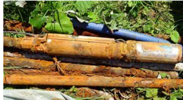
Ausgebaute Pumpe und alte Steigrohre: Es war höchste Zeit!
